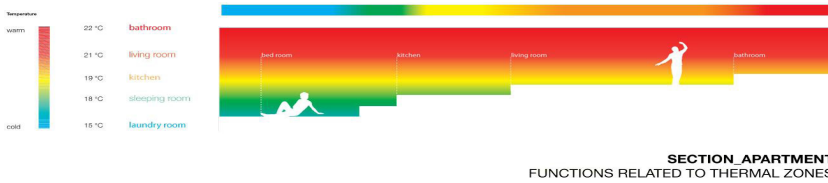
Resim 11. Archimedes House, Mekân içindeki ısı dağılımını gösteren termodinamik kesit, Philippe Rahm, Vassivière, 2005 (URL-5).
